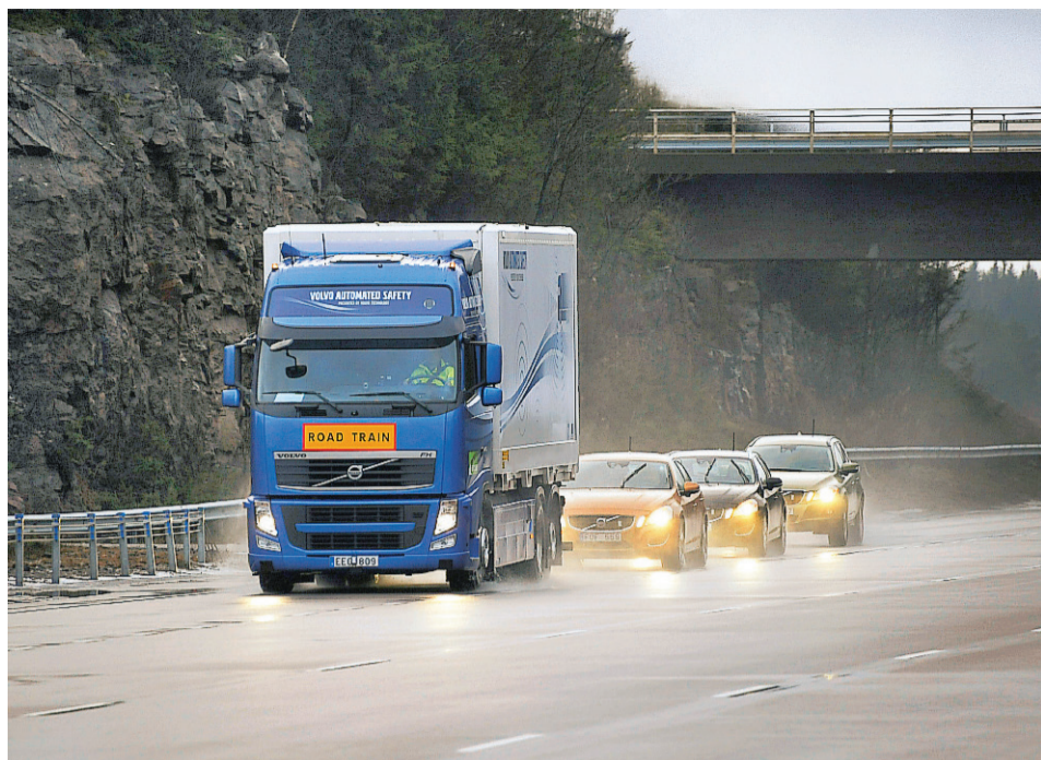
Водитель грузовика Volvo с помощью датчиков и WiFi может управлять движением целой автоколонны / VOLVO CAR CORPORATION
